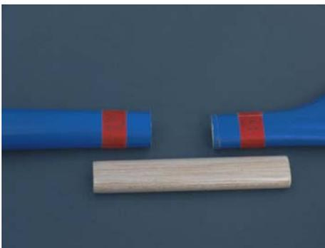
Für die geplante Reparatur braucht man eine GFK-Hülse, auf die sich die Rumpfstücke möglichst passend aufschieben lassen. Die Länge der Hülse richtet sich nach der erforderlichen Einschiebetiefe und der Länge des zerstörten Bereiches.
