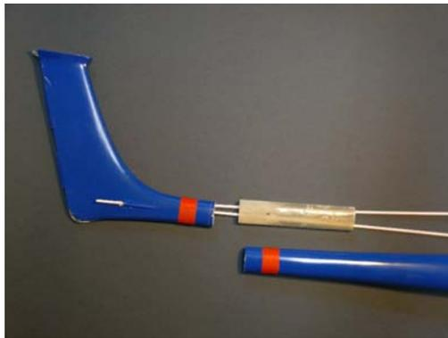
Jetzt ist der richtige Zeitpunkt zum Einkleben und Anschließen der neuen Bowdenzüge im hinteren Rumpfstück, danach geht es an das Verbinden der beiden Rumpfteile. Ich habe die Hülse zuerst mit dem Rumpfeende verklebt, um das endgültige Verbinden der Rumpfstücke zu erleichtern. Wer mutig ist, kann beide Klebestellen in einem Arbeitsgang erledigen.
