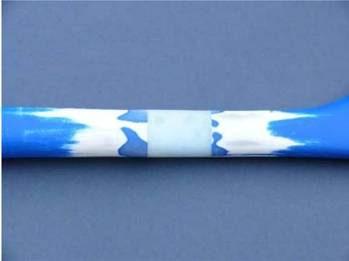
Nach dem Aushärten muss die an der Reparaturstelle noch fehlende Rumpfwand mit Gewebe oder Spachtelmasse ersetzt werden und nach dem unvermeidlichen Schleifen und Spachteln kann die Neulackierung des Rumpfes erfolgen.
